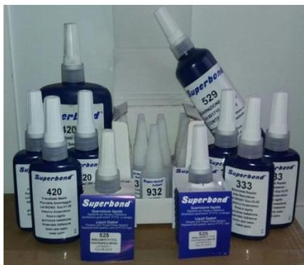
*I prodotti Superbond sono speciali adesivi anaerobici ad un solo componente. Sono liquidi che induriscono quando vengono a trovarsi fra due superfici metalliche da collegare, l'aria è l'inibitore: conserva il prodotto liquido, il metallo è il catalizzatore: attiva l'indurimento*
